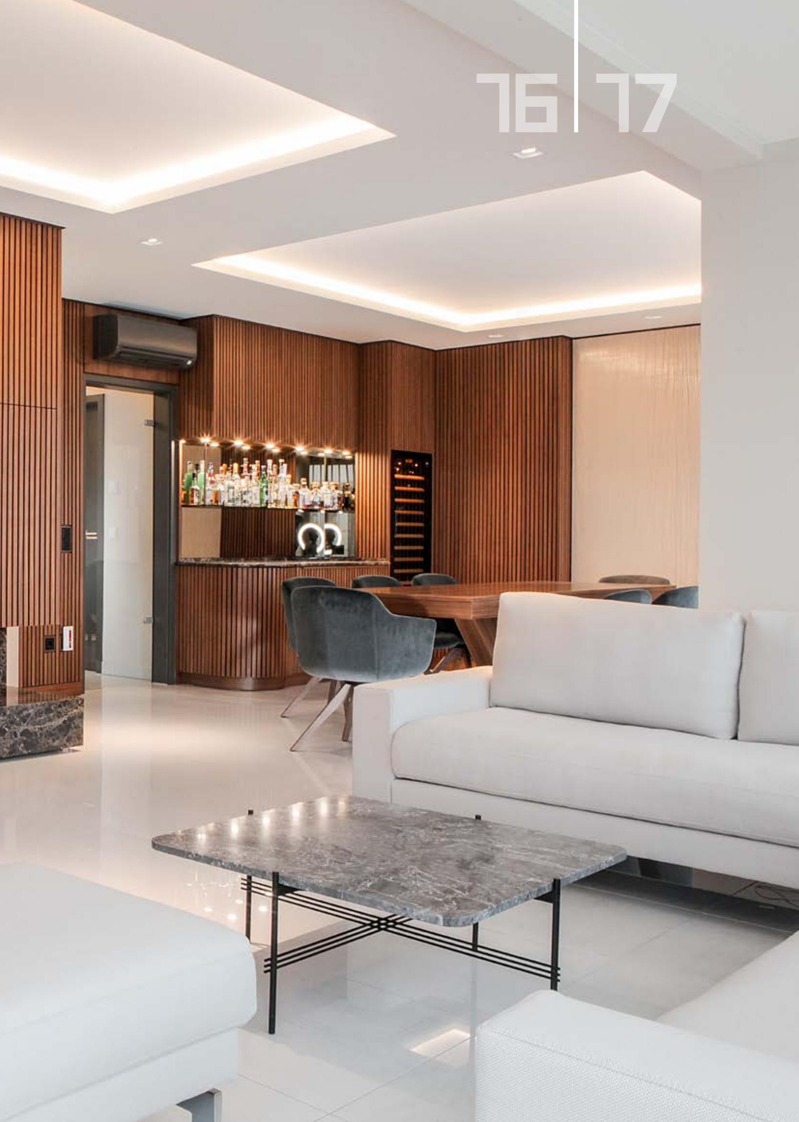
Stab an Stab, Vollholz an Vollholz, Nussbaum, 25 mal 25 Millimeter, 10 Millimeter Schattenfuge, das ist die Basis aus dem dieses ganz besondere Büro gebaut ist. Der Kunde wollte eine multifunktionale Wohlfühlatmosphäre mit dem Kick Repräsentation und dem Quäntchen Status, dass seinem Unternehmen und seinen Kunden auch gerecht werden kann.
